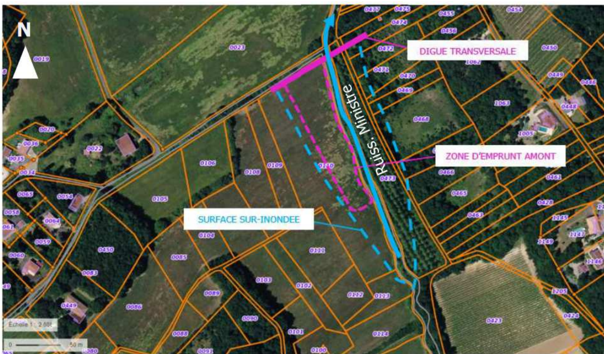
Figure 2 : Digue de Pitot
