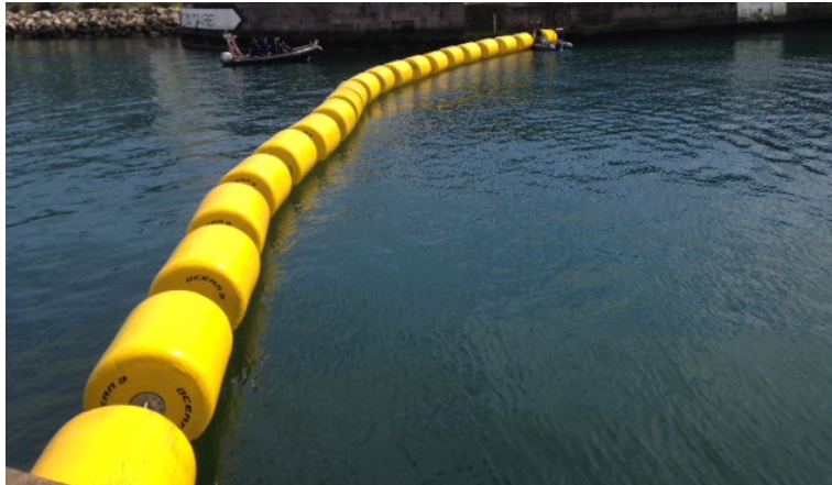
Figure 3 : Barrage flottant en situation. Source : société Océan3
